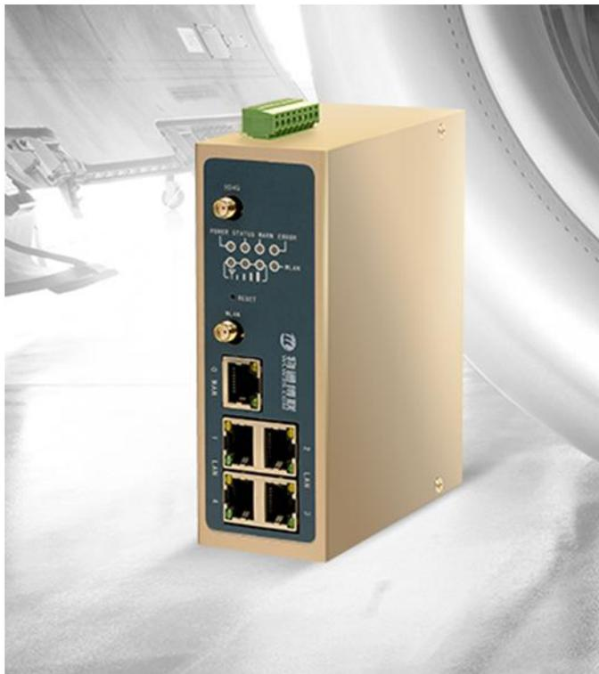
WG285 系列工业智能网关是一款五个网口，支持 4G/3G/WIFI 等各种网络接入方式、支持各种工控协议解析，支持 MQTT 上行协议，支持网关信息采集管理，支持设备和变量的定义和远程部署、支持自定义方式的数据采集和数据控制和支持防火墙等功能为一体的嵌入式工业级智能网关。
